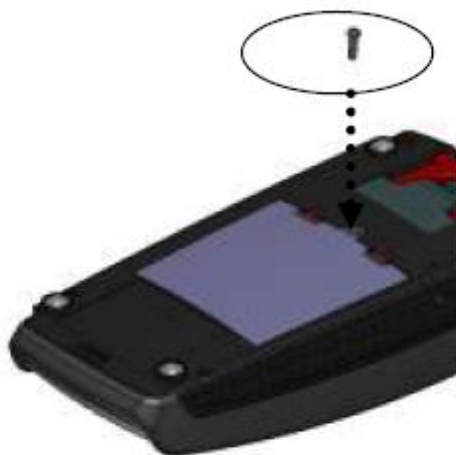
Рис. 7 Установка модуля считывания бесконтактных карт 3
